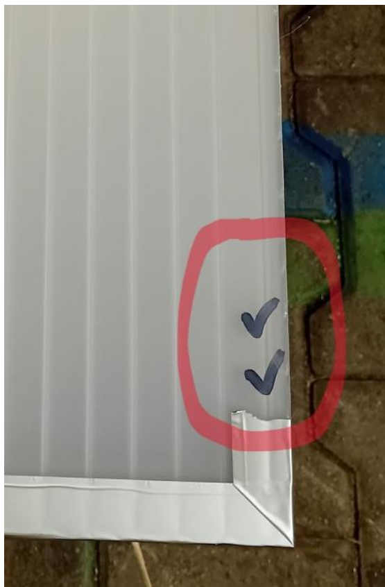
Rys. 37 Sposób oznaczania strony UV-odpornej płyt poliwęglanowych.
