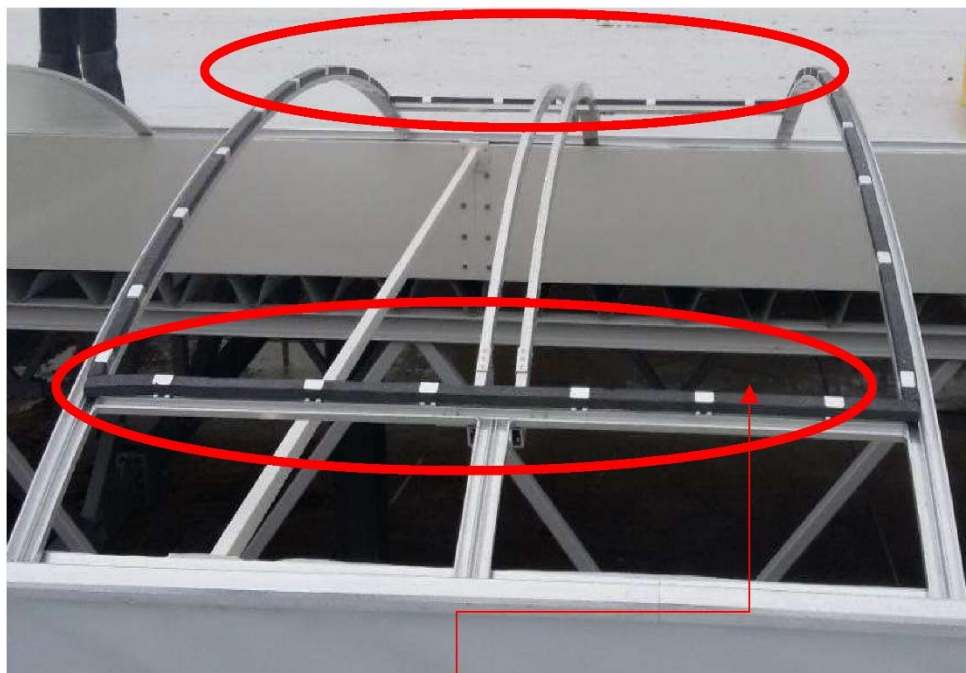
Rys. 47 Sposób rozmieszczenia konsol na pająku.
