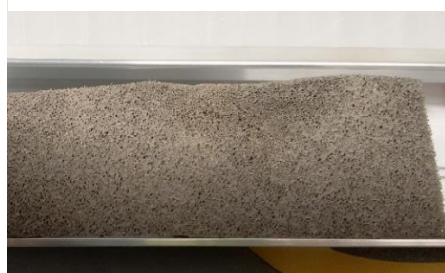
Rys. 35 Uszczelka rozprężna po rozprężeniu
